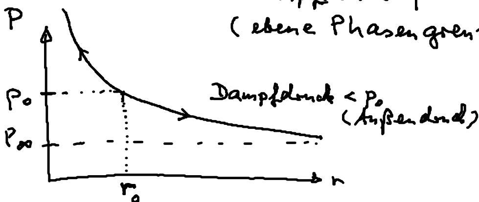
Außendruck geg.  $\Rightarrow \exists r_0$  so dass für  $r > r_0$  das Tröpfchen anwächst (Kondensation), für  $r < r_0$  kleiner wird (Evaporation)
