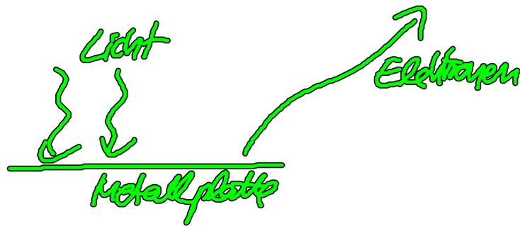
Oberhalb einer bestimmten Grenzfrequenz  $\nu_0$  (materialabhängig) des eingestrahelten Lichts treten aus der Metalloberfläche Elektronen aus („Photoelektronen“)
