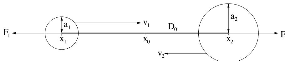
Zwei Kugeln mit Radien  $a_1 \leq a_2$  sind durch ein Verbindungsstück der Länge  $D(t) = D_0 - Ut$  miteinander verbunden. Für  $t > 0$  wird das Verbindungsstück also gleichmäßig verkürzt ( $U > 0$ ) und die Kugeln beginnen sich zu bewegen. Benutzen Sie im Folgenden die Oseen-Näherung
