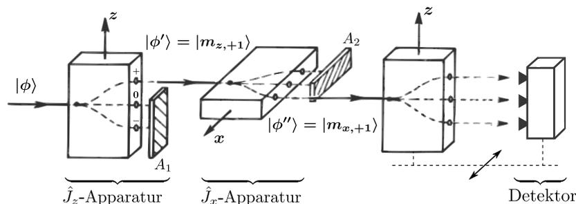
Abbildung 1: Durch sein magnetisches Moment wird ein Atom in einem räumlich variierenden Magnetfeld abgelenkt. Mittels Absorbern  $A_1$  und  $A_2$  kann es in einem Zustand präpariert und schließlich im Detektor gemessen werden.
